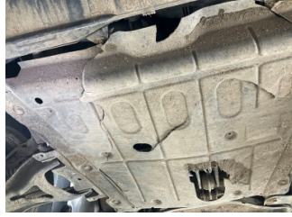
Motor, Alt muhafaza > Hasarlı
