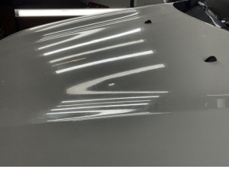
Kaporta, Kaporta > Dolu Hasarı
