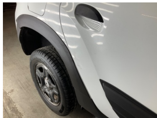
Kapı, sağ arka, Kapı, sağ arka > Ezik
