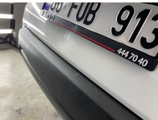
Bagaj kapağı/kapısı, Bagaj kapısı > Ezik
