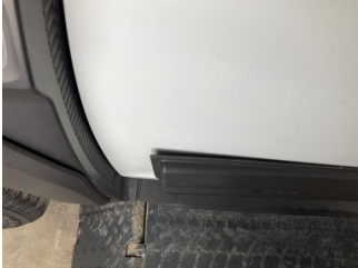
Kapı, sol ön, Kapı bandı > Sabitlemesi Hatalı
