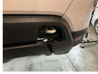
Tampon, arka, Çeki demir kapağı > Sökülmüş-Yok
