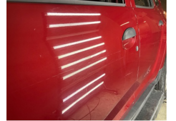
Kapı, sol ön, Kapı, sol ön > Çizik
