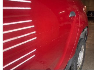
Kapı, sol arka, Kapı, sol arka > Çizik
