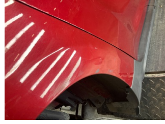
Çamurluk, sağ arka, Çamurluk, sağ arka > Ezik
