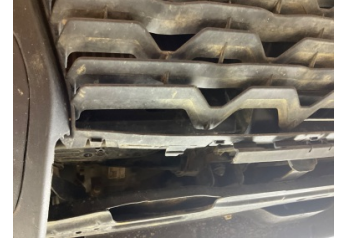
Tampon, ön, Ön tampon ızgarası > Hasarlı
