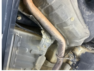
Egzoz sistemi, Susturucu muhafaza sacı orta > Sabitlemesi Hatalı
