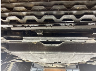
Tampon, ön, Tampon koruyucu orta > Sökülmüş-Yok
