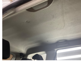
Döşemeler/Kapaklar, Tavan döşemesi > Deforme Olmuş
