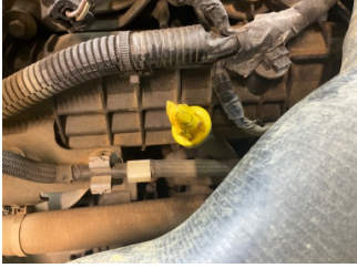
Motor, Yağ kontrol cubuğu > Hasarlı
