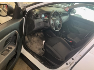
Döşemeler/Kapaklar, Döşemeler/Kapaklar > Kirlenmiş
