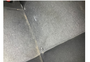
Döşemeler/Kapaklar, Döşemeler/Kapaklar > Yakıcı Madde Ile Zarar Görmüş
