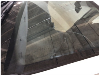
Camlar, Ön cam > Hasarlı
