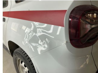
Çamurluk, sol arka, Çamurluk, sol arka > Hasarlı
