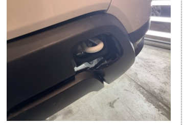
Tampon, arka, Çeki demir kapağı > Sökülmüş-Yok
