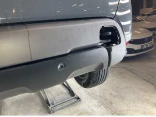
Tampon, arka, Çeki demir kapağı > Sökülmüş-Yok
