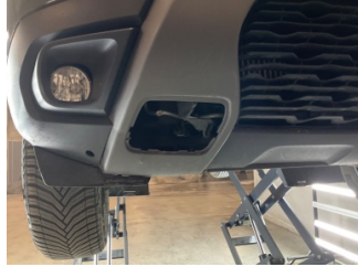
Tampon, ön, Çeki demir kapağı > Sökülmüş-Yok
