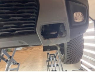
Tampon, ön, Çeki demir kapağı > Sökülmüş-Yok
