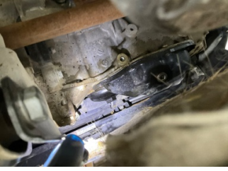
Motor, Motor > Yağ Kaçağı
