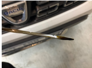
Motor, Yağ seviyesi > Eksik
