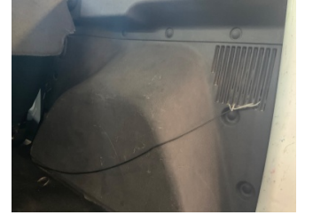
Döşemeler/Kapaklar, Bagaj bölümü döşemesi > Hasarlı
