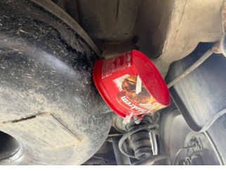
LPG/CNG sistemi, Tank > Standart Dışı Onarım
