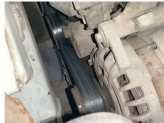
Motorsoğutması, Kayış > Deforme Olmuş
