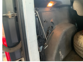
Döşemeler/Kapaklar, Bagaj bölümü döşemesi > Hasarlı
