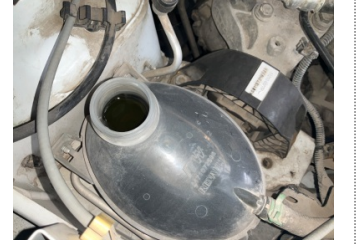
Motorsoğutması, Soğutma sıvısı > Pas
