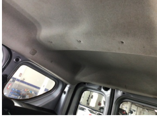
Döşemeler/Kapaklar, Tavan döşemesi > Deforme Olmuş
