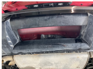
Tampon, arka, Spoiler > Eksik
