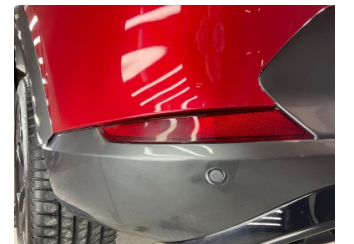
Tampon, arka, Spoiler > Sabitlemesi Hatalı
