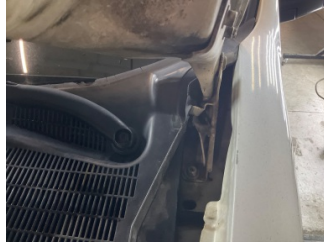
Motor kaputu, Menteşe > Hasarlı
