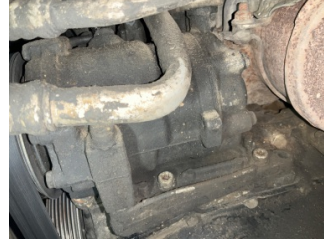
Motor, Motor > Yağ Kaçağı
