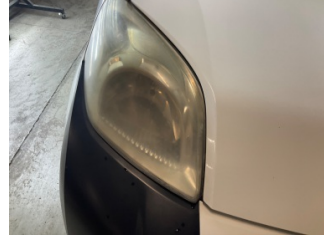
Komünikasyon/Navigasyon/Eğlence Farlar, Far camı, sağ > sistemleri, Anten > Hasarlı
