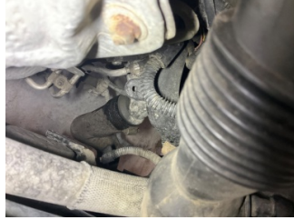
Motor, Motor > Yağ Kaçağı
