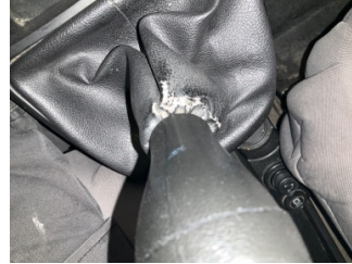
Şanzıman, Vites körüğü > Hasarlı
