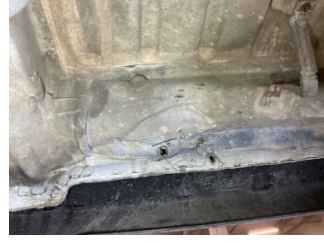
Arka bölüm, Bagaj havuzu > Hasarlı
