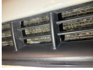
Motorsöğütması, Radyatör > Ezik
