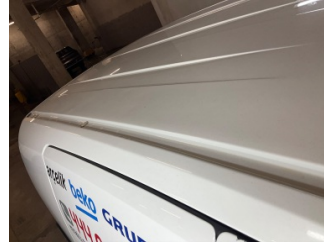
Tavan, Tavan > Hasarlı
