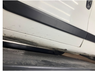
Marşbiyel, sol, Marşbiyel, sol > Hasarlı
