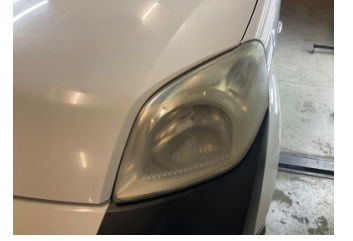
Farlar, Far camı, sol > Deforme Olmuş
