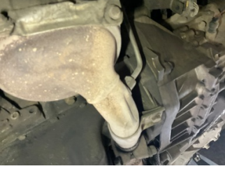
Egzoz sistemi, Partikül filtresi > Ezik
