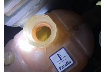
Motorsoğutması, Soğutma sıvısı > Kirlenmiş
