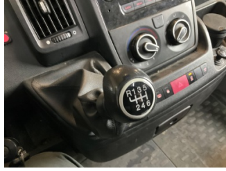
Şanzıman, Vites topuzu > Deforme Olmuş
