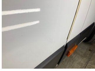
Kapı, sağ arka, Kapı, sağ arka > Çizik
