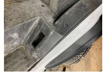
Döşemeler/Kapaklar, Döşemeler/Kapaklar > Eksik
