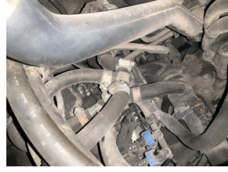
Motorsoğutması, Hortumlar > Standart Dışı Onarım
