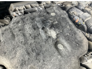
Motor, Motor üst kapağı, plastik > Deforme Olmuş
