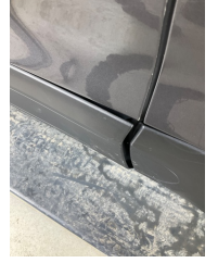
Kapı, sol ön, Kapı bandı > Sabitlemesi Hatalı
