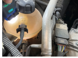
Motorsoğutması, Soğutma sıvısı > Eksik
