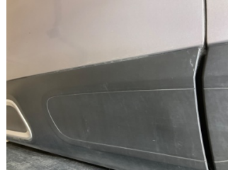
Kapı, sol ön, Kapı bandı > Çizik
