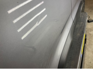
Kapı, sağ arka, Kapı, sağ arka > Ezik
