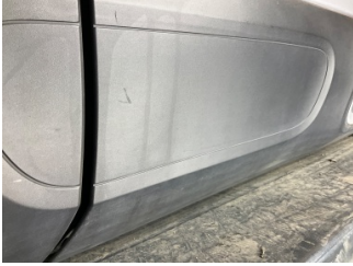
Kapı, sağ ön, Kapı bandı > Çizik
