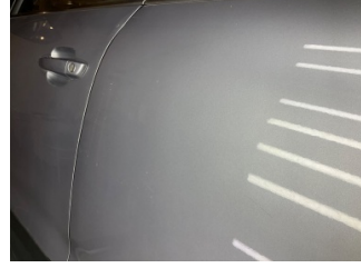
Kapı, sol arka, Kapı, sol arka > Çizik
