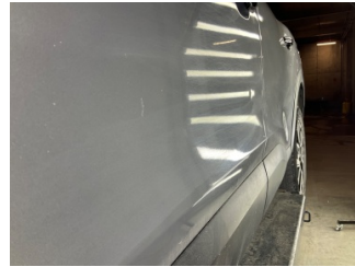
Kapı, sol ön, Kapı, sol ön > Vuruk
