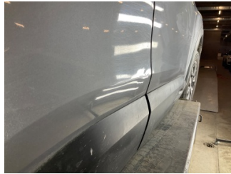
Kapı, sağ arka, Kapı, sağ arka > Ezik
