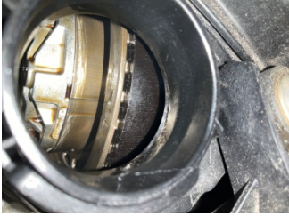
Motor, Triger kayışı > Çatlak
