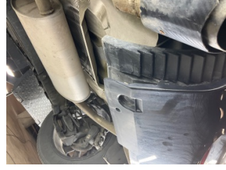
Tampon, arka, Spoiler > Sabitlemesi Hatalı
