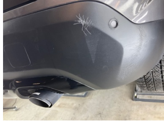
Tampon, arka, Arka tampon > Boyası Atmış
