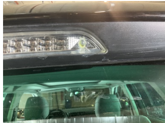
Arka lambalar, Üçüncü fren lambası > Çatlak
