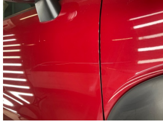
Kapı, sağ ön, Kapı, sağ ön > Çizik
