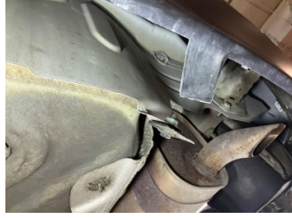
Tampon, arka, Bağlantı ayağı > Hasarlı
