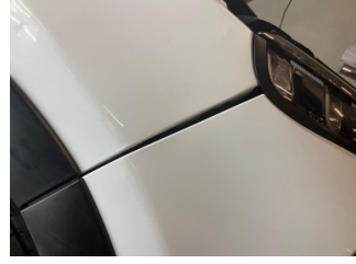
Tampon, ön, Ön tampon > Sabitlemesi Hatalı
