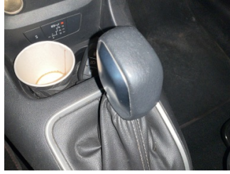
Şanzıman, Vites topuzu > Deforme Olmuş
