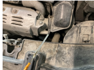
Motor, Yağ seviyesi > Eksik
