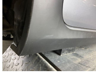
Marşbiyel, sağ, Marşbiyel plastığı, sağ > Çizik
