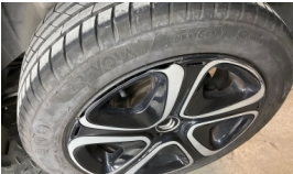
Jant kapağı, sol arka > Hasarlı
