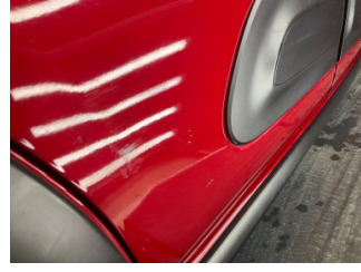
Kapı, sağ arka, Kapı, sağ arka > Ezik
