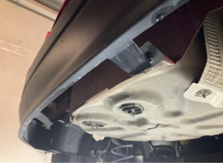
Tampon, arka, Bağlantı ayağı > Hasarlı
