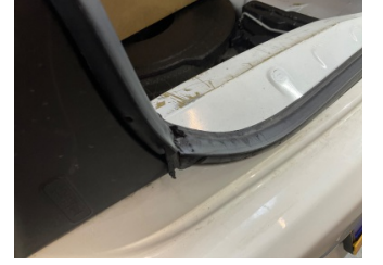
Arka bölüm, Bagaj kapağı fitili > Hasarlı
