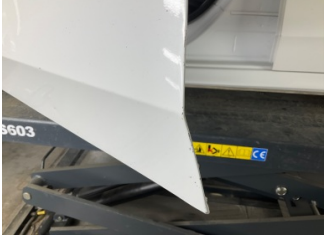
Kapı, sol ön, Kapı, sol ön > Boyası Atmış
