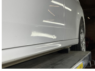
Kapı, sol ön, Kapı, sol ön > Ezik
