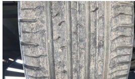
Lastik, ön > Çatlak
