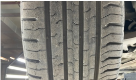
Lastik, ön > Çatlak
