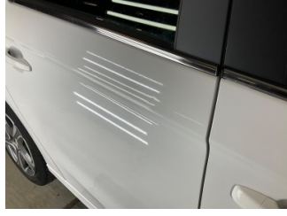
Kapı, sağ arka, Kapı, sağ arka > Ezik
