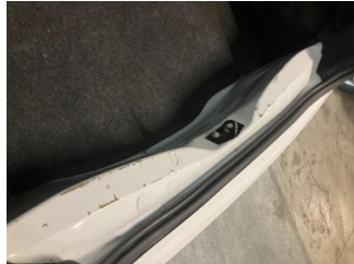
Döşemeler/Kapaklar, Yükleme eşiği kaplaması > Çizik
