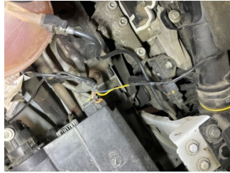
Elektrik donanımı/Pano, Kablo demeti > Standart Dışı Onarım
