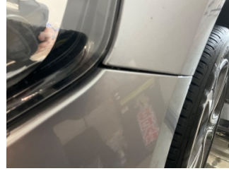
Tampon, ön, Ön tampon > Sabitlemesi Hatalı
