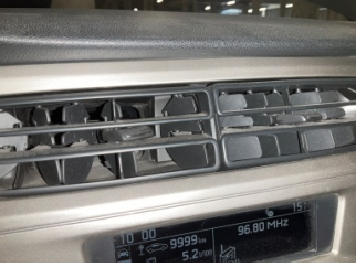
Kalorifer/Klima, Havalandırma izgarası sabitlemesi > Hasarlı
