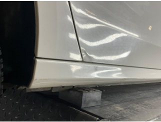
Kapı, sağ arka, Kapı, sağ arka > Ezik
