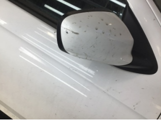
Dikiz aynası, sağ, Dış dikiz aynası > Çizik
