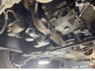
Motor, Alt muhafaza > Sökülmüş-Yok
