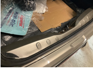
Döşemeler/Kapaklar, Yükleme eşiği kaplaması > Çizik
