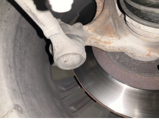
Direksiyon sistemi, Rot kolu/Rot başı, sol > Hasarlı
