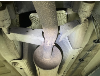
Egzoz sistemi, Orta susturucu > Sabitlemesi Hatalı
