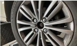
Jant göbeği kapağı, ön sağ > Sökülmüş-Yok
