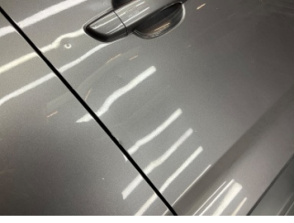
Kapı, sağ arka, Kapı, sağ arka > Ezik
