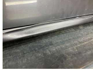
Marşbiyel, sağ, Marşbiyel, sağ > Hasarlı
