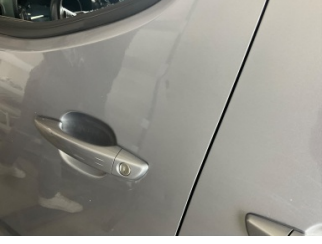
Kapı, sol ön, Kapı, sol ön > Ezik
