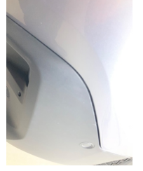
Tampon, ön, Spoiler > Sabitlemesi Hatalı
