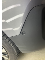
Tampon, ön, Spoiler > Sabitlemesi Hatalı
