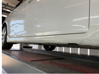
Marşbiyel, sağ, Marşbiyel plastiği, sağ > Hasarlı
