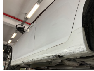
Marşbiyel, sol, Marşbiyel plastiği, sol > Hasarlı
