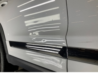
Kapı, sağ arka, Kapı, sağ arka > Ezik
