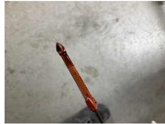
Motor, Yağ seviyesi > Eksik
