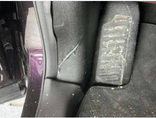
Döşemeler/Kapaklar, A-direk iç kaplaması, sol > Standart Dışı Onarım
