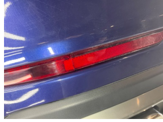
Tampon, arka, Reflektör, sol > Hasarlı
