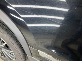
Kapı, sağ arka, Kapı, sağ arka > Çizik
