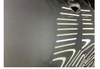
Kapı, sol ön, Kapı, sol ön > Noktasal Ezik
