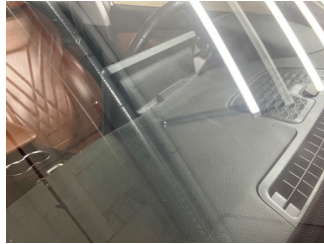
Camlar, Ön cam > Çatlak
